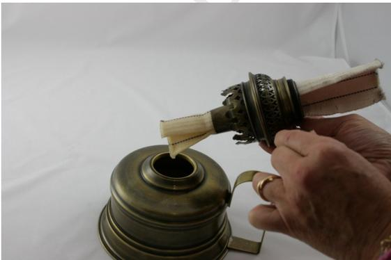
Repositionner la mèche de façon à la faire sortir de quelques millimètres comme ci-contre.
